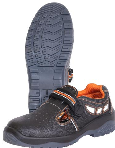
Верх обуви изготовлен из кожи со специальным покрытием для защиты от ОПЗ. Подкладка: типика. Подошва: промежуточный слой ПУ, ходовой слой ТПУ. В полуботинках SAVEL-Европа в носочной части устанавливается термопласт, который сохраняет форму полуботинка. Перфорация носочной части полуботинка обеспечивает вентиляцию стопы. Рекомендуются к использованию работниками различных отраслей промышленности, складских и сервисных служб.
