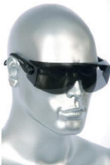
Очки для защиты глаз спереди и с боков от попадания стружки, осколков, капель жидкостей. Регулировка дужек подлинне и углу постановки. Мягкие ПВХ накладки на переносице.
