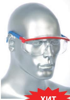
Универсальные защитные открытые очки с панорамным стеклом, оптический класс 1, увеличенная защита сверху и по бокам. 100% защита от УФ-излучения. Регулировка по длине дужки и углу наклона. Масса не более 35 г
