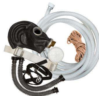
Противогаз шланговый с естественной подачей воздуха предназначен для защиты органов дыхания, глаз и лица человека от аэрозолей и паров (газов) любых вредных веществ, присутствующих в атмосферном воздухе, при их концентрации не более 2000 ПДК, а также для работы в условиях недостаточного содержания кислорода в рабочей зоне (менее 17% объёмных).
